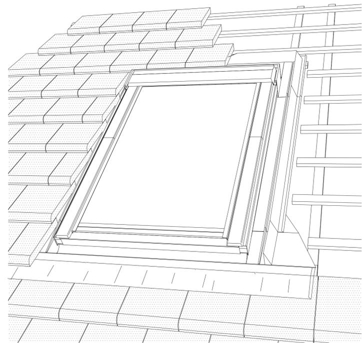
Gouttière de sous-toiture livrée avec la BFX
