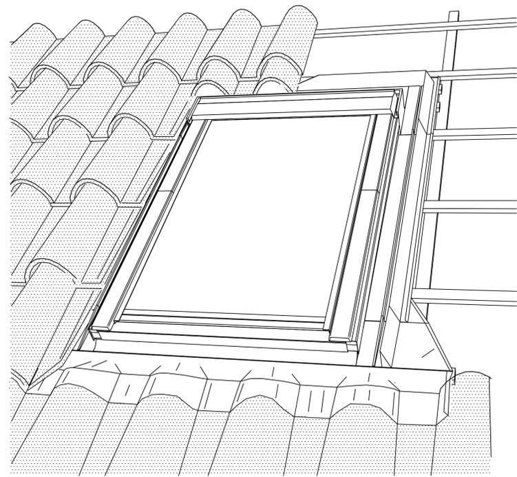
Gouttière de sous-toiture livrée avec la BFX
